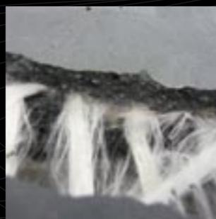
*Glasfaserbeton (GFB) ist ein Verbundwerkstoff aus hochwertigem Feinbeton und alkaliresistenten Glasfasern. Durch die Kombination zweier an sich spröder Werkstoffe wird ein duktileres Material erhalten, das sich durch eine hohe Biegezugfestigkeit und Schlagfestigkeit und ein ausgeprägtes Arbeitsvermögen auszeichnet.*
